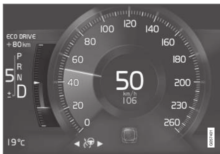
Wskaźnik ECO na 8-calowym wyświetlaczu kierowcy. Wskaźnik ECO pokazuje stopień efektywności paliwowej jazdy:
