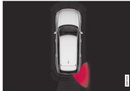
Podświetlona ikona funkcji CTA w polu graficznym Układ wspomaganie parkowania na ekranie wyświetlacza.
