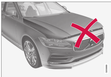
Niedomknięta pokrywa silnika.
