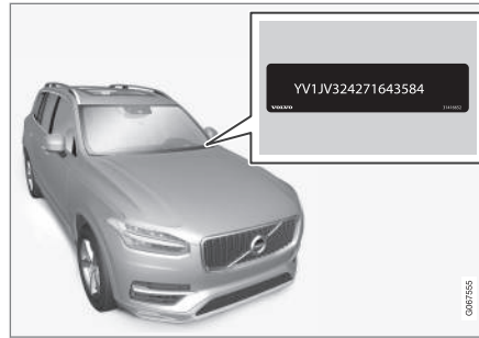
A VIN minden modellen hasonló helyen helyezkedik el.
