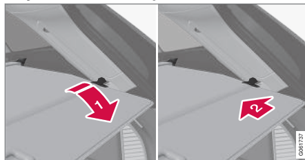
Csomagtértakaró teljesen takaró helyzetben.
