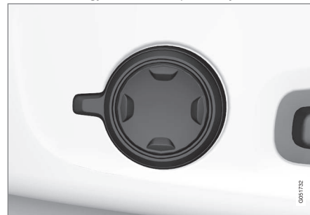
Többfunkciós kezelőszerv, az ülés ülőrésének oldalán.
