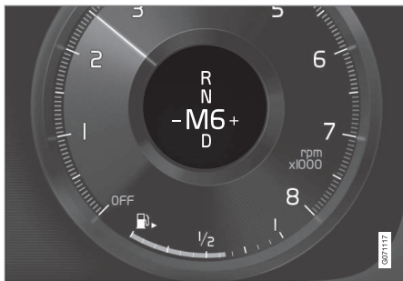
A fokozatváltás visszajelzése 12-hüvelykes járművezetői kijelzőn, kis sebességváltó karral*.
