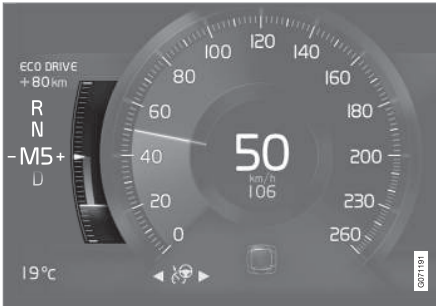
Eco műszer a 8-hüvelykes járművezetői kijelzőn.
