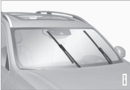
Az ablaktörlő lapátok a szervizállásban.
