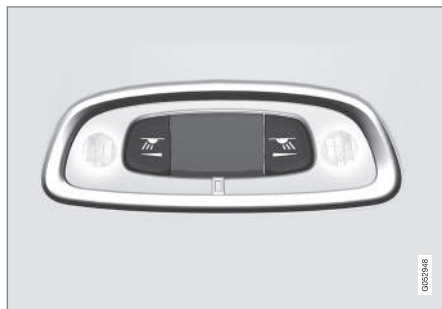
Olvasólámpák a hátsó ülés felett.
