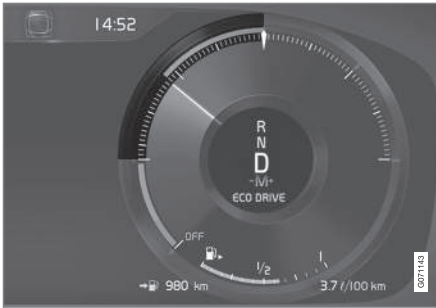
Eco műszer a 12-hüvelykes járművezetői kijelzőn*.
