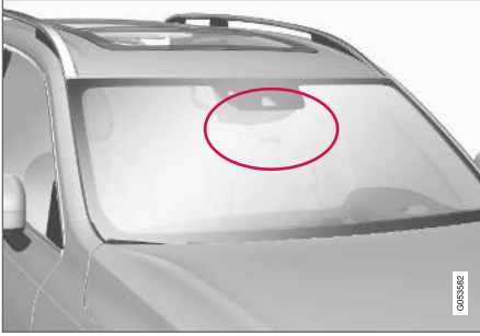
Radar ünitesi konumu
