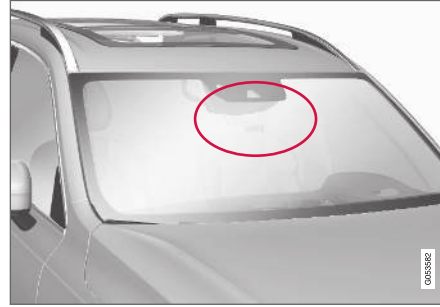
Radar ünitesi konumu
