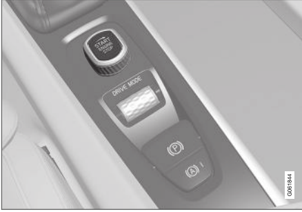
Tünel konsolundaki çalıştırma düğmesi.
