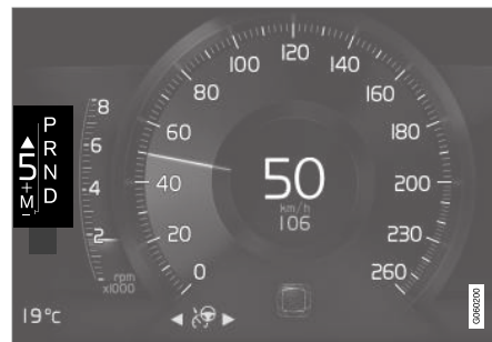
Fokozatváltás-jelző a 8-hüvelykes járművezetői kijelzőn.
