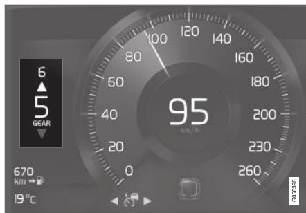
Fokozatváltás-jelző a 8-hüvelykes járművezetői kijelzőn.
