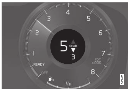
Fokozatváltás-jelző a 12-hüvelykes járművezetői kijelzőn*.
