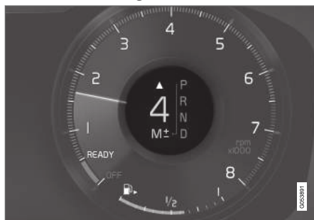
Fokozatváltás-jelző a 12-hüvelykes járművezetői kijelzőn*.
