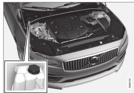
Hűtőfolyadék tágulási tartálya, balkormányos autó.
