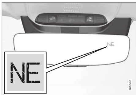
Visszapillantó tükör iránytűvel.
