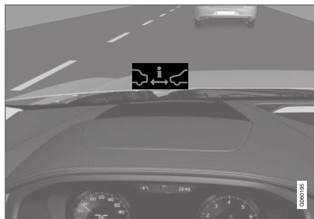
Távolságfigyelmeztetés szimbólum a szélvédőn szélvédőre vetített kijelzővel.
