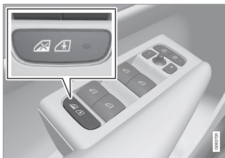
Przycisk do elektrycznej aktywacji i dezaktywacji.
