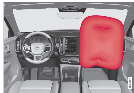
Czołowa poduszka powietrzna pasażera przedniego fotela.
