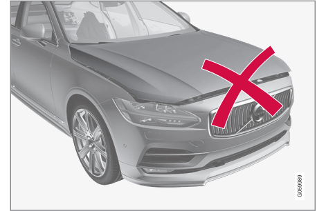
Niedomknięta pokrywa silnika.
