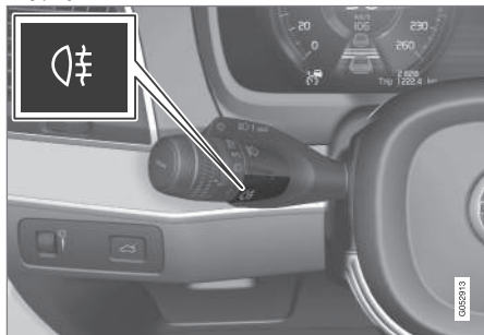
Wyłącznik tylnego światła przeciwmgielnego.
