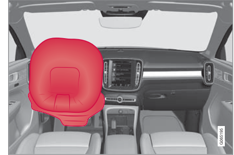
الوسادة الهوائية في عجلة القيادة والوسادة الهوائية عند الركبة ١ في جانب السائق في المقعد الأمامي.
