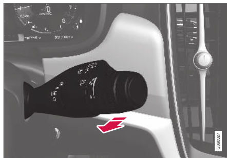
Fonction lave-glace, levier droit au volant
