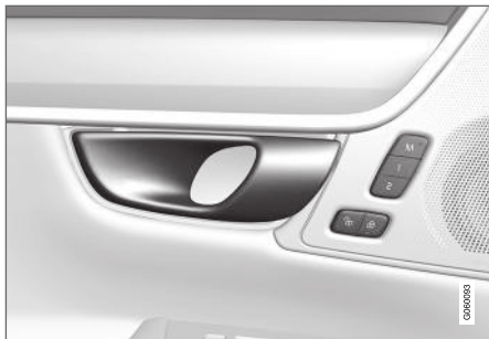
Poignée d'ouverture pour le déverrouillage alternatif d'une porte latérale.
