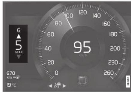
Indicateur de rapport sur l'écran conducteur 8 pouces.
