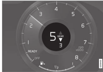
Indicateur de rapport sur l'écran conducteur 12 pouces*.
