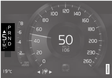
Indicateur de rapport sur l'écran conducteur 8 pouces.
