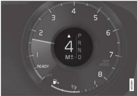
Indicateur de rapport sur l'écran conducteur 12 pouces*.
