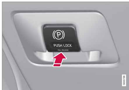
Stāvbremzes vadība - ieslēgšana.
