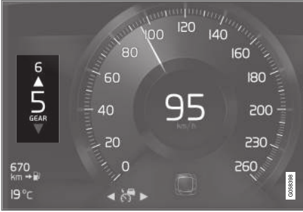
8 inç sürücü gösterge ekranındaki vites değiştirme göstergesi.
