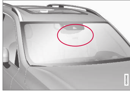
Radar ünitesi konumu
