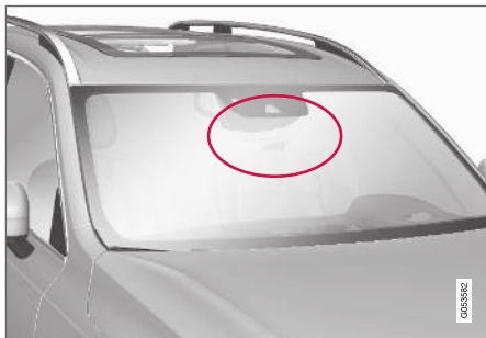
Emplacement de l'unité radar.
