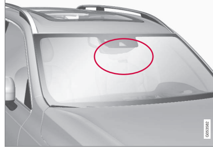
Radar ünitesi konumu
