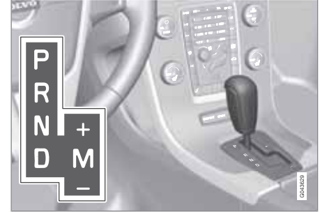
D: Otomatik vites konumları. M (+/-): Düz vites konumları.
