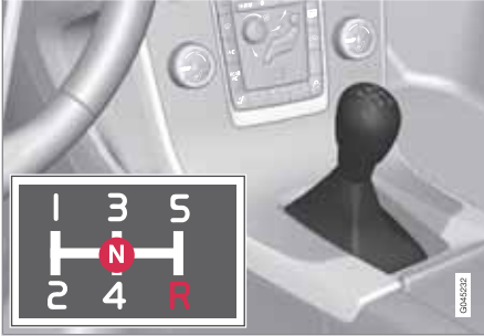
Vites değiştirme düzeni 5 vitesli şanzıman.
