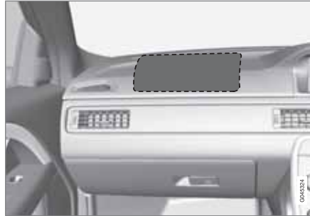
Sağdan direksiyonlu araçlarda ön yolcu hava yastığının konumu.
