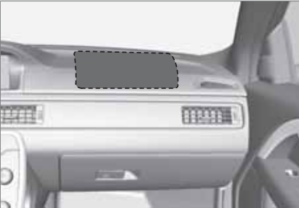
Soldan direksiyonlu araçlarda ön yolcu hava yastığının konumu.
