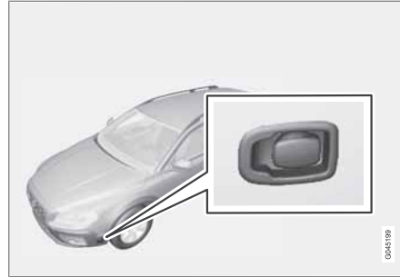
Motor bloğu ısıtıcısına elektrik girişi.
