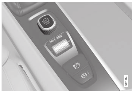
Startbryteren i tunnelkonsollen.
