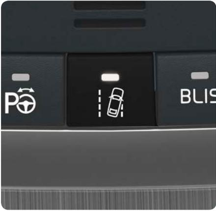
Si la voiture se met à dévier, LKA remet activement la voiture dans sa voie à l'aide d'un léger couple dans le volant. Si la voiture dépasse un marquage au sol latéral, LKA vous avertit par des vibrations dans le volant.
