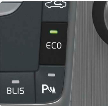
Une pression sur le bouton **ECO** active un programme de conduite optimal et économe en carburant impliquant les modifications suivantes :
