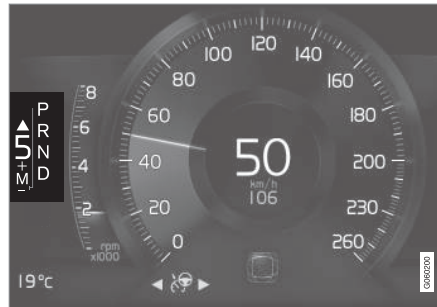
Indicateur de rapport sur l'écran conducteur 8 pouces, pour gros levier de vitesse.
