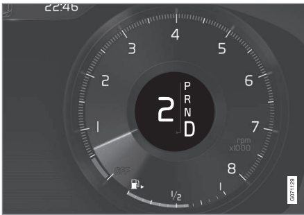
Écran conducteur lors d'un changement de rapport avec les palettes du volant, gros levier de vitesses.
