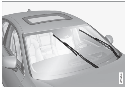
Balais d'essuie-glace en position d'entretien.
