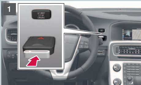
1. Transpondersleutel in het contactslot plaatsen en tot aan de aanslag naar binnen duwen.
