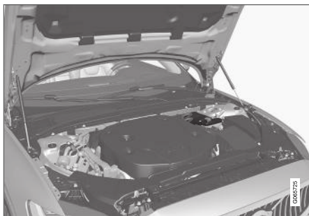
Atbalsta akumulators atrodas dzinēja nodalījumā.
