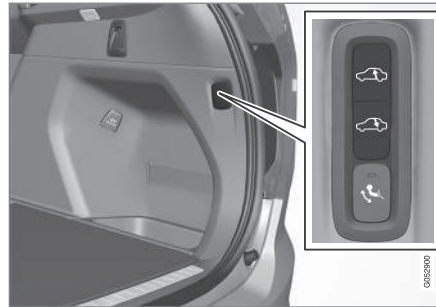
Vadības slēdži automašīnas aizmugures pacelšanai/nolaīšanai
