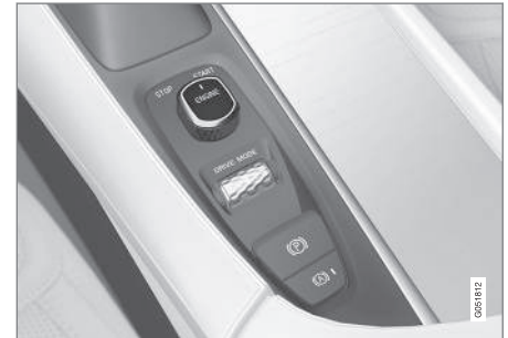
Iedarbināšanas slēdzis tuneļkonsolē.
