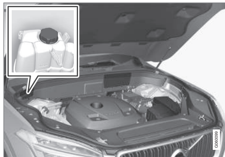
Dzesēšanas šķidruma izplešanās tvertne.
