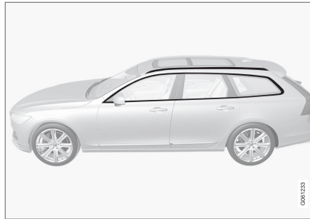
Alkatrészek, amelyek 3,5 és 11,5 pH-érték közötti tisztítószerrel moshatók.
