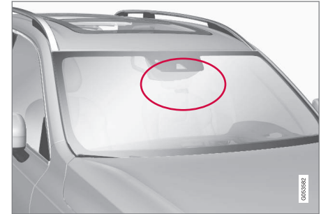
A radar egység elhelyezkedése.
