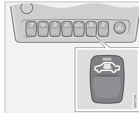
Можно временно отключать датчики движения и крена для предотвращения непреднамеренного срабатывания сигнализации, например, если в автомобиле оставлена собака, или во время перевозки автомобиля на пароме.
