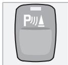
При запуске двигателя система всегда активирована. Нажмите кнопку для отключения/восстановления системы предупреждающей о движении задним ходом. См.
