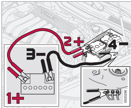
Если аккумуляторная батарея разрядилась, можно "позаимствовать" электроэнергию от отдельного аккумулятора или от другого автомобиля. Во избежание искрообразования при попытке пуска двигателя обязательно проверьте надежность крепления зажимов на пусковых проводах.
