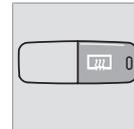
Обогрев используется для удаления обледенения и запотевания с заднего стекла и зеркал заднего вида. При нажатии на выключатель запускается обогрев заднего стекла и зеркал заднего вида. Лампа в выключателе светится. Обогрев автоматически отключается прим. через 12 минут.
