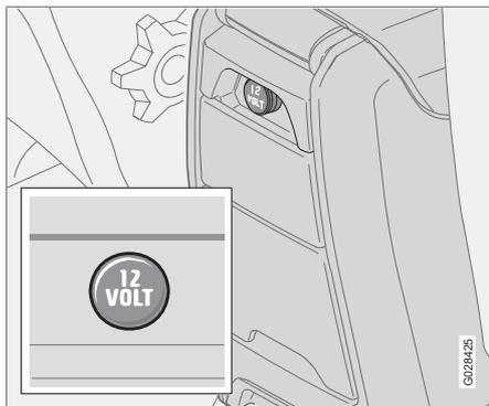
Электрическое гнездо можно использовать для различного дополнительного оборудования, например, мобильного телефона или холодильника. Оно рассчитано на 12 В. Макс. сила тока 10 А. Дистанционный ключ должен находиться, как минимум в положении I, чтобы на гнездо подавалось питание.
