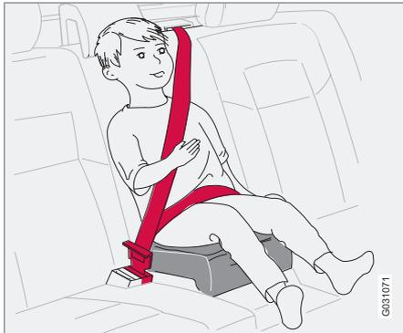
Встроенная фиксируемая ремнем подушка Volvo для среднего места заднего сидения специально сконструирована в расчете на обеспечение оптимальной безопасности ребенка. В комбинации со штатными ремнями безопасности эта встроенная опорная подушка рассчитана на детей весом от 15 до 36 кг.
