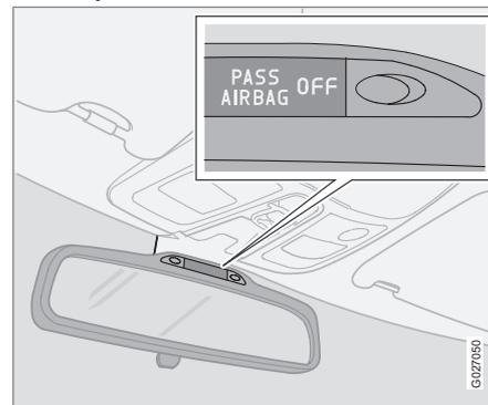
Индикация, указывающая на отключенную подушку безопасности на стороне пассажира.
