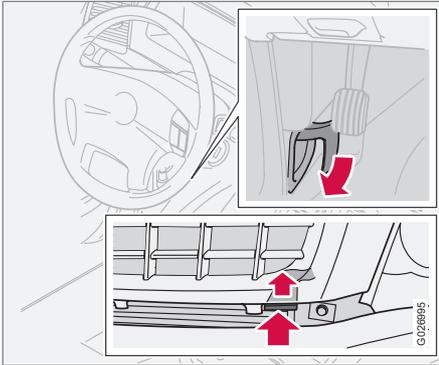
1. Потяните за ручку отпирания в глубине слева (или справа для автомобилей с правосторонним управлением) под приборной панелью. Вы услышите, как откроется замок.
