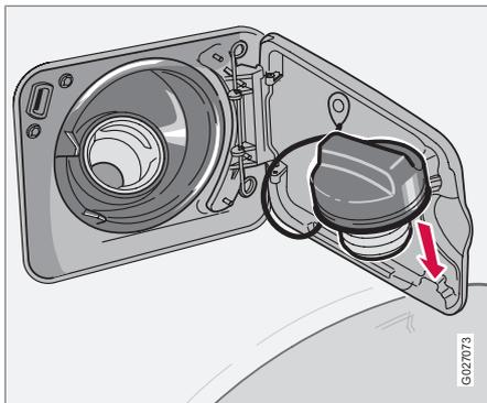
Пробка заливной горловины находится под крышкой на заднем крыле с правой стороны и ее можно навесить изнутри на крышке топливного бака.
