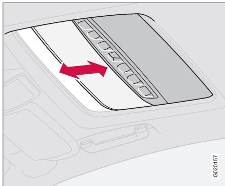
У люка также имеется внутренняя солнцезащитная шторка, перемещаемая вручную. Когда люк открывается, солнцезащитная шторка автоматически сдвигается назад. Чтобы закрыть шторку, сдвиньте ее вперед за ручку.
