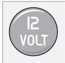
Электрическое гнездо можно использовать для подключения различного дополнительного оборудования на 12 В, например, мобильного телефона или холодильника.
