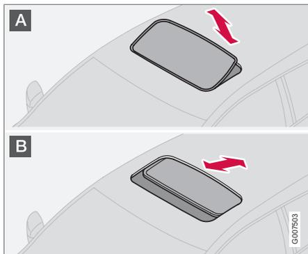
Органы управления люком в крыше расположены на потолке. Люк можно открыть в два положения:
