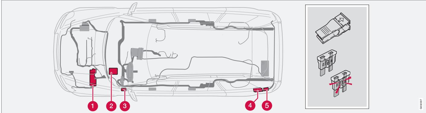
Протяжка проводки может различаться в зависимости от варианта двигателей. При этом сохраняется однотипное расположение компонентов, приведенных в списке.
