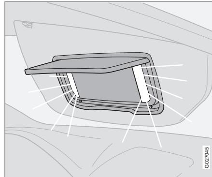
Лампа включается автоматически при подъеме крышки.
