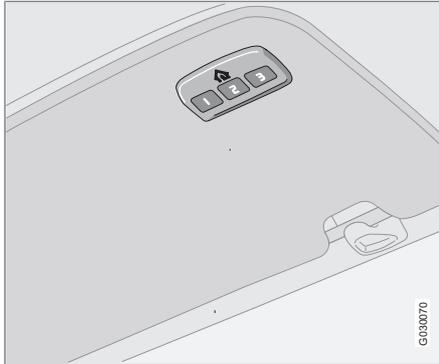
HomeLink® – это программируемый дистанционный пульт, с помощью которого можно управлять работой до трех различных устройств (например, ворота гаража, система охранной сигнализации, освещение внутри и снаружи помещения и т.п.), заменяя, таким образом, пульты дистанционного управления этих устройств. HomeLink® встроено в левый солнцезащитный козырек.
