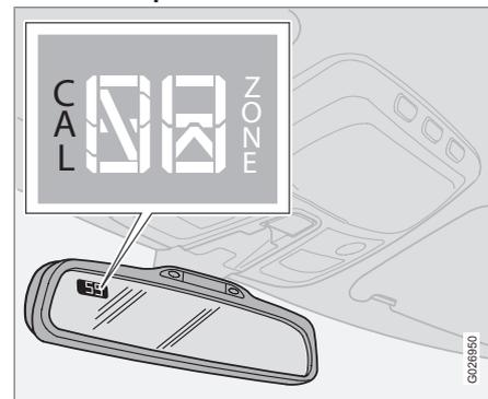
Земной шар разделен на 15 магнитных зон. Компас настроен на тот географический регион, в который осуществлена поставка данного автомобиля. Необходимо провести калибровку компаса, если автомобиль перемещается в другие магнитные зоны.
