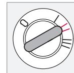
Положение дистанционного ключа во время движения. Электросистема двигателя подключена.
