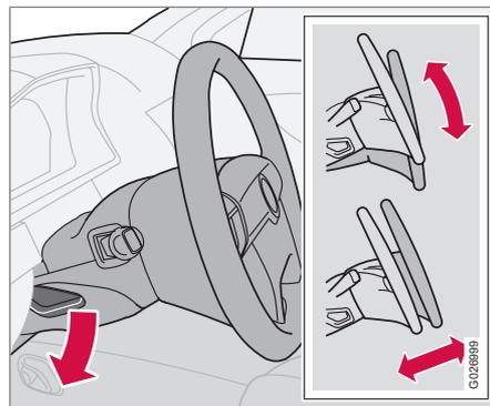
Рулевое колесо можно регулировать по высоте и в продольном направлении. Нажмите вниз рычаг с левой стороны рулевой колонки. Затем установите рулевое колесо в наиболее удобное положение. Отожмите обратно рычаг, чтобы зафиксировать руль. Если при этом возникают затруднения, нажмите слегка на руль, одновременно отжимая рычаг обратно.
