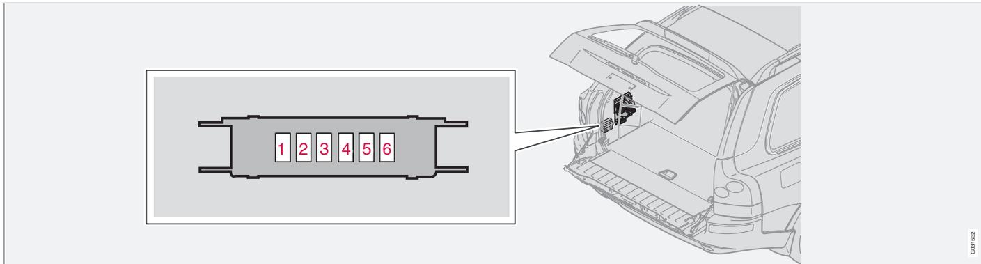
Блок предохранителей расположен за защитной панелью с левой стороны.
