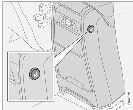
Кнопка для включения/отключения обогрева задних сидений.
