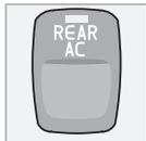
Нажмите на кнопку для активирования кондиционирования воздуха в задней части салона. Кондиционирование в задней части салона отключается при выключении зажигания.
