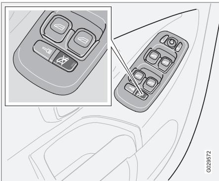
Блокирование задних стеклоподъемников и электрическая блокировка замков для безопасности детей\*.
