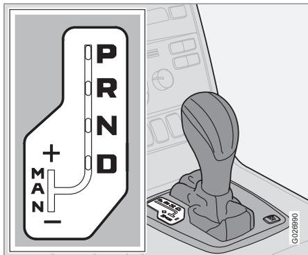
Для перехода из автоматического режима **D** в режим ручного переключения передач отведите рычаг в положение **M**. Для перехода из положения **M** в автоматический режим для движения **D** отведите рычаг в положение **D**.
