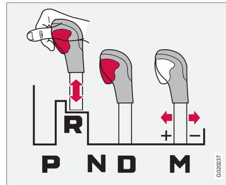
Вы можете всегда перемещать рычаг селектора передач свободно вперед или назад между положениями **N** и **D**. На других положениях передач установлен блокиратор, который управляется кнопкой блокировки на рычаге селектора передач.
