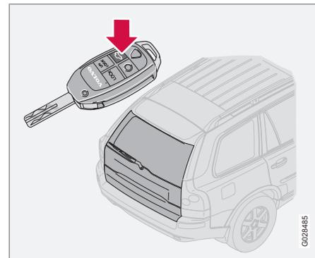
Если в автомобиле установлена охранная сигнализация\*, индикатор сигнализации на приборной панели гаснет, указывая, что сигнализация частично отключена. Датчики уровня и движения, а также датчики открытия двери задка отключаются.
