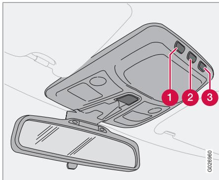
Кнопки управления в потолочной консоли передними лампами для чтения и освещением салона.
