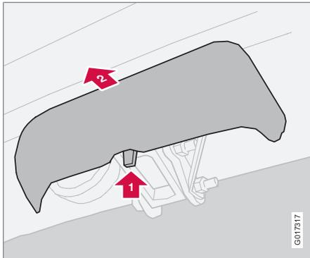
1. Снимите защитную крышку, надавив сначала на фиксатор,
