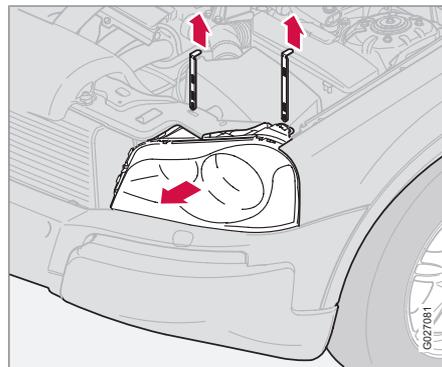
При замене ближнего и дальнего света фар, габаритных/стояночных огней необходимо снять всю вставку с лампами. Для замены одной из этих ламп проделайте указанное ниже, а затем посмотрите инструкции для соответствующей лампы.
