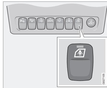
Для активирования/отключения блокировки для безопасности детей в задних дверях пользуйтесь кнопкой в центральной консоли.
