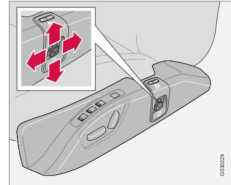
Кнопка для регулировки опоры поясницы.
