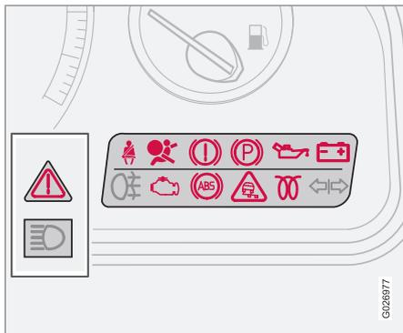
Перед пуском двигателя все контрольные и предупреждающие символы<sup>1</sup> включаются после поворота дистанционного ключа в положение II. Так проверяется функционирование символов. После запуска двигателя все символы гаснут, за исключением ручного тормоза, который гаснет после отпущения тормоза.
