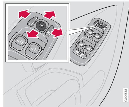
Регулятора установки двух внешних зеркал заднего вида находятся в передней части подлокотника водителя. Зеркалами заднего вида можно управлять в положении зажигания I и II.
