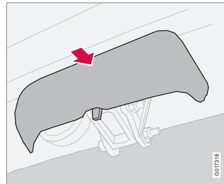
4. Задвиньте защитную крышку.
