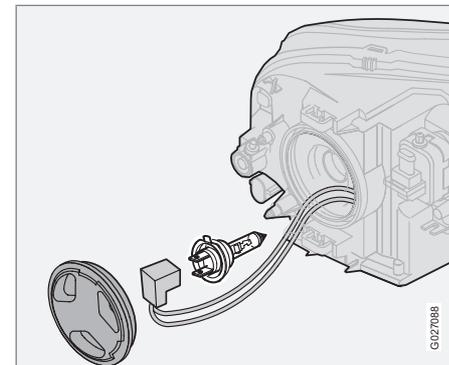
1. Снимите внешнюю накладную крышку, повернув её против часовой стрелки.
