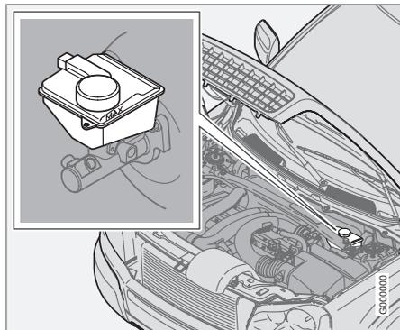
Жидкость тормозов и сцепления заливается в общий бачок<sup>1</sup>. Уровень должен лежать между отметками **MIN** и **MAX**. Регулярно проверяйте уровень. Заменяйте жид-
