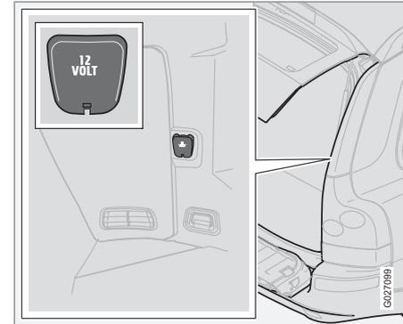
Для использования розетки откиньте крышку. Розетка находится под напряжением независимо от того, включено зажигание или нет.
