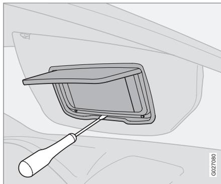
1. Вставьте плоскую отвертку сбоку от среднего зажима в нижнем крае зеркала. Подними вверх так, чтобы отжать средний зажим.
