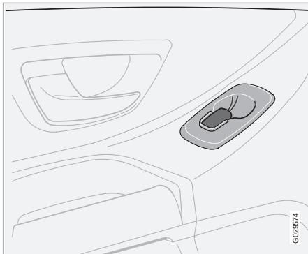
Управление стеклами задних дверей возможно, как клавишами соответствующих дверей, так и выключателем с двери водителя. Если в выключателе блокировки стеклоподъемников задних дверей (расположенном на панели управления двери водителя) горит лампа, управление стеклоподъемниками задних дверей возможно только с двери водителя.
