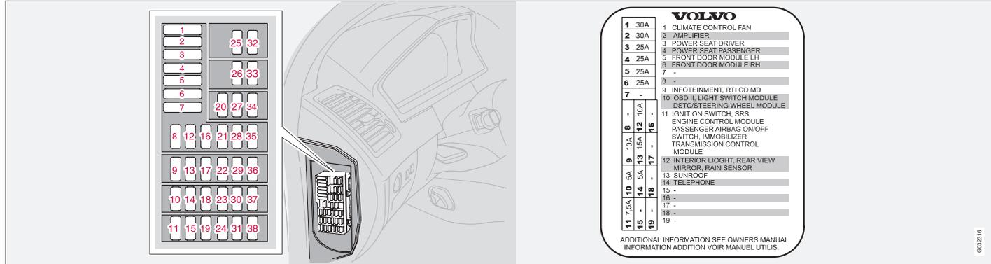
Наклейка с указанием позиции предохранителей и числа ампер расположена под крышкой торцевого блока.
