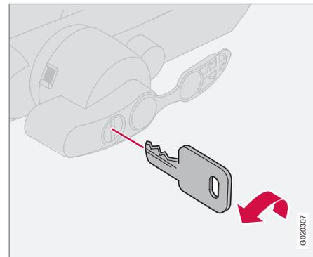
6. Поверните ключ против часовой стрелки в запертое положение. Выньте ключ из замка.
