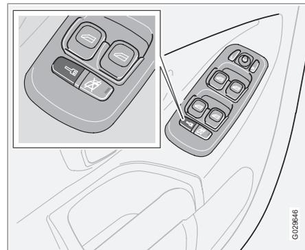
Автоматическое запирание активируется и отключается с панели управления в двери водителя. Функция означает, что двери запираются автоматически на скорости автомобиля выше 7 км/ч. Двери остаются запертыми до тех пор, пока какая-либо дверь не открывается изнутри, или если все двери отпираются с панели управления.
