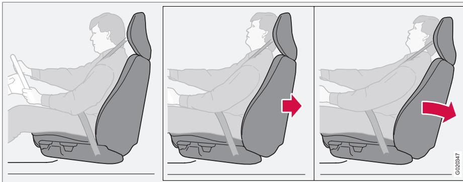
Система WHIPS (Whiplash Protection System) состоит из энергопоглощающей спинки и специально модернизированного для данной системы подголовника в передних сиденьях. Система активируется в момент удара сзади, и ее срабатывание зависит от угла удара, скорости и вида транспортного средства, нанесшего удар.
