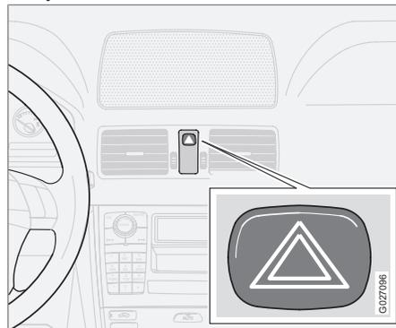
Аварийную мигающую сигнализацию (мигают все указатели поворотов) следует использовать, когда автомобиль стоит в таком месте, где он может создавать опасность или помехи для других транспортных средств. Нажмите на кнопку для включения данной функции.
