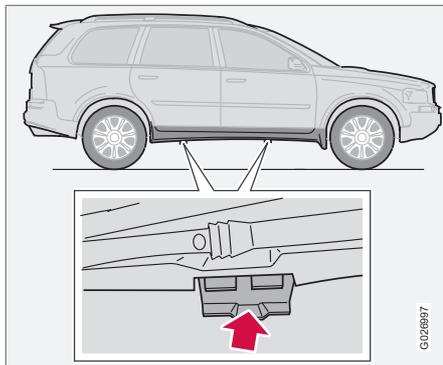
Если колесо необходимо заменить в местах с дорожным движением, не забудьте установить треугольный знак аварийной остановки. На автомобиле с каждой стороны имеется по два упора для установки домкрата, расположенные по центру под нижним краем дверей.
