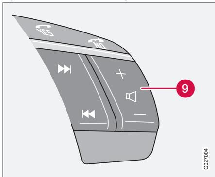
Четыре нижние клавиши клавиатуры на руле общие для радио и для телефона. Функция кнопки зависит от того, какая система активирована. При помощи клавиатуры на руле вы можете регулировать звук, переключаться между запрограммированными станциями и менять дорожку на компакт-диске. Две верхние кнопки на кнопоч-
