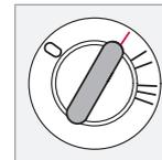
Могут быть подключены определенные электрические компоненты. Электросистема двигателя не подключена.
