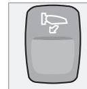
Используется для складывания внешних зеркал заднего вида из открытого положения и раскрытия из сложенного положения.
