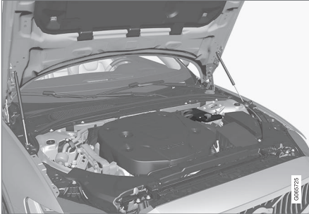
Akumulator pomocniczy 12 V znajduje się w komorze silnika.
