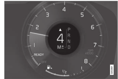
Pavarų perjungimo indikatorius 12 colių vairuotojo ekrane*.
