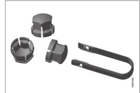
Plastikinių dangtelių nuėmimo nuo ratų varžtų įrankis.
