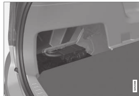
Starterio akumuliatoriaus įrengtas bagažinėje.
