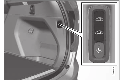
Automobilio galinės dalies pakėlimo / nuleidimo valdymo elementai
