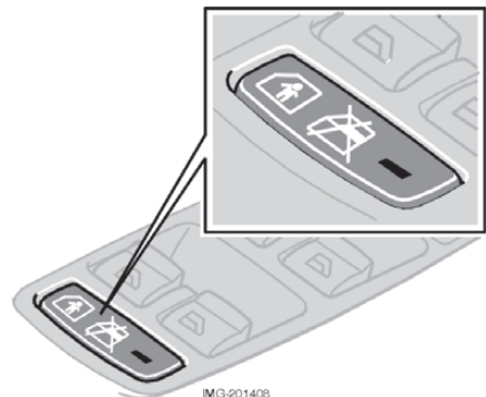
Elektrisk spärr för öppning av bakdörr och fönster bak
