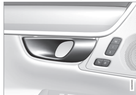
Poignée d'ouverture pour le déverrouillage alternatif d'une porte latérale 12 .
