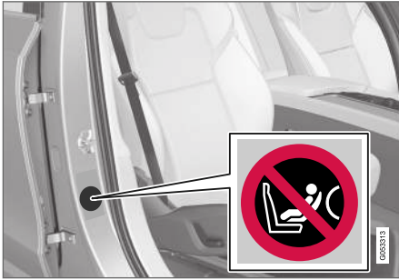
Yolcu tarafı kapı direğindeki etiket. Etiket yolcu kapısı açıldığında görünür.
