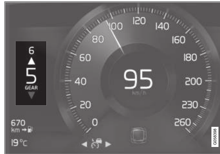
Indicateur de rapport sur l'écran conducteur 8 pouces.
