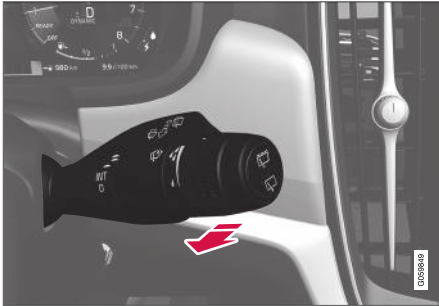
Fonction lave-glace, levier droit au volant
