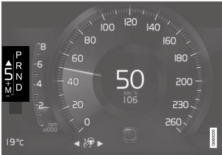
Indicateur de rapport sur l'écran conducteur 8 pouces.
