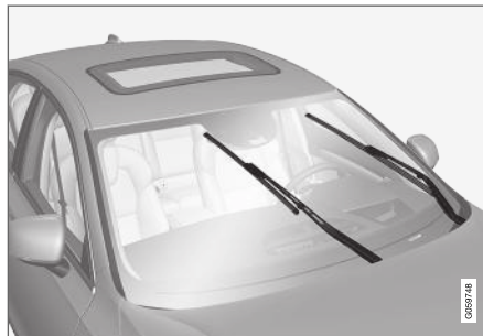
Balais d'essuie-glace en position d'entretien.
