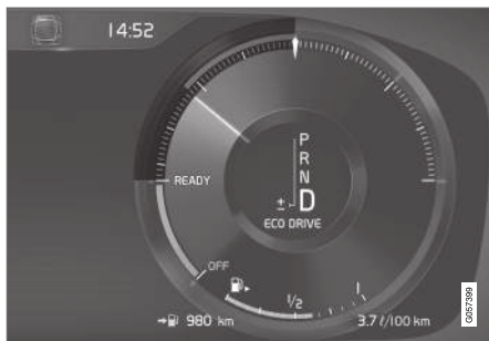
Compteur ECO sur l'écran conducteur 12 pouces*.
