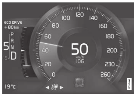
Compteur ECO sur l'écran conducteur 8 pouces.
