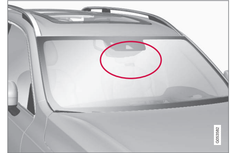
Umiejscowienie modułu radarowego.
