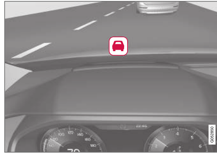
Ütközésfigyelmeztető szimbólum a szélvédőn 51 .
