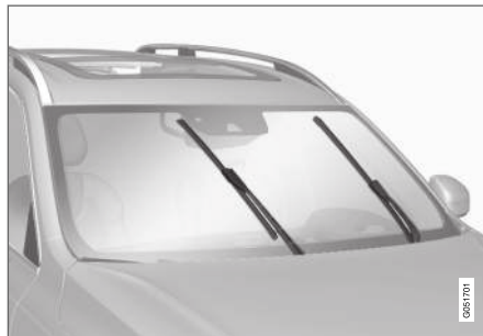
Az ablaktörlő lapátok a szervizállásban.
