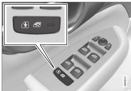
Gomb az elektromos aktiváláshoz és inaktíváláshoz.
