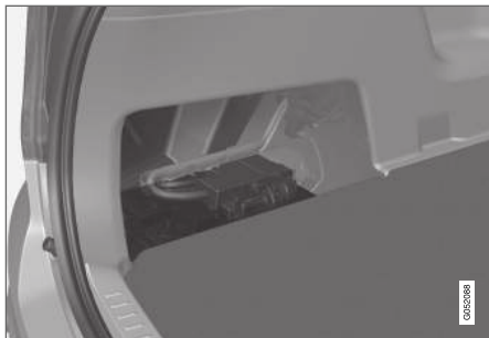
Az indítóakkumulátor a csomagterben helyezkedik el.
