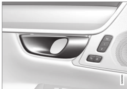
Nyitó fogantyú az oldalajtó alternatív nyitásához 15 .
