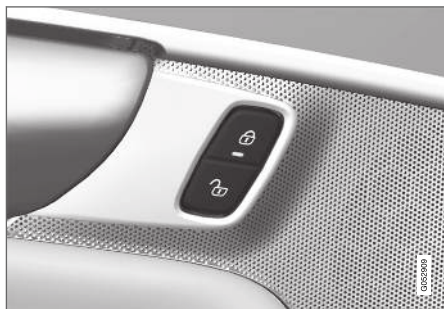
Záró és nyitó gomb visszajelző lámpával az első ajtóban.
