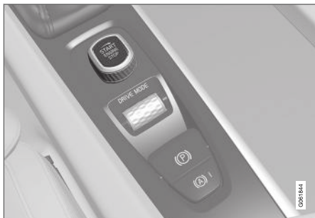
Pokrętło rozruchu na konsoli między fotelami.
