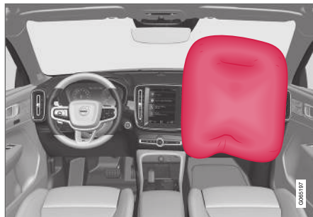
Kollisjonspute på passasjersiden i forsetet.
