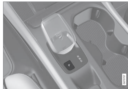
Prezentacja dźwigni zmiany biegów i położenia P
