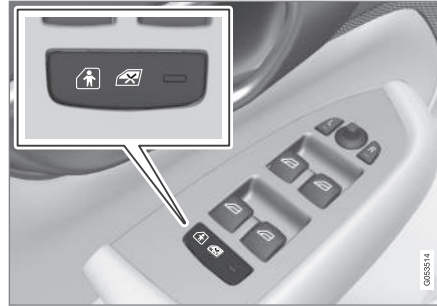
Przycisk do elektrycznej aktywacji i dezaktywacji.
