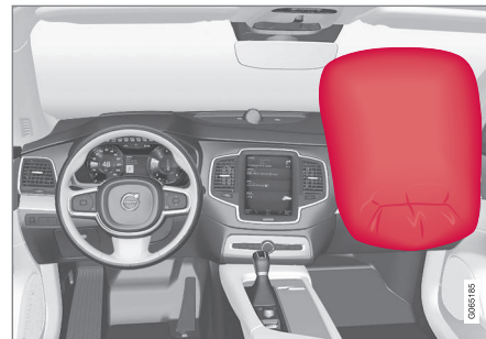
Czołowa poduszka powietrzna pasażera przedniego fotela.
