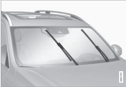
Pióra wycieraczek w pozycji serwisowej.
