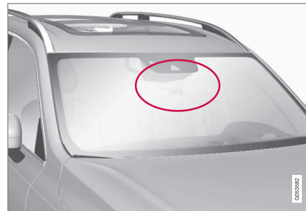
Umiejscowienie modułu radarowego.
