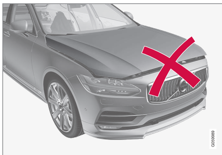
Niedomknięta pokrywa silnika.
