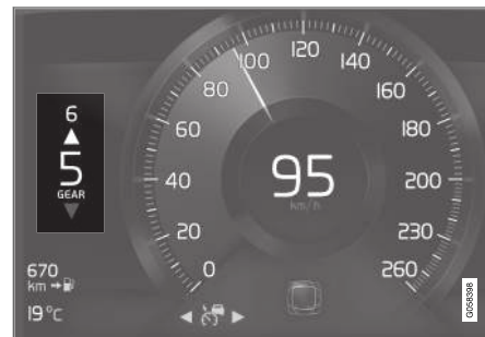
Pārnesumu pārslēgšanas indikators 8 collu vadītāja displejā.
