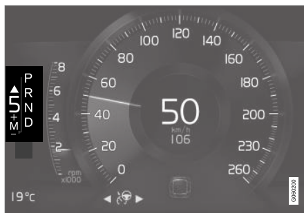
Pārnesumu pārslēgšanas indikators 8 collu vadītāja displejā.
