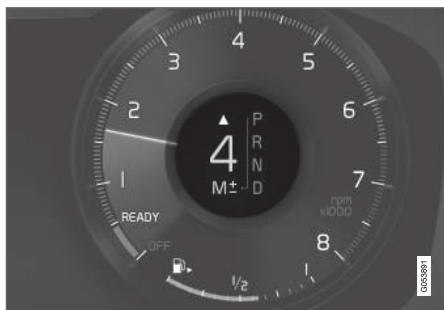
Pārnesumu pārslēgšanas indikators 12 collu vadītāja displejā*.
