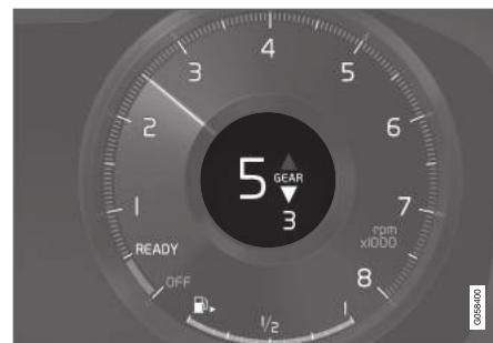
Pārnesumu pārslēgšanas indikators 12 collu vadītāja displejā*.
