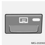
Используйте обогрев для удаления льда и запотевания с заднего стекла и наружных зеркал заднего вида.
