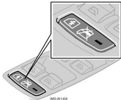
*Электроуправляемый замок задних дверей и окон*
