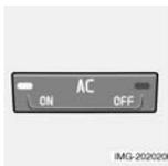
Когда светится светодиод ВКЛ. (ON), система кондиционирования находится в автоматическом режиме управления. В этом режиме поступающий
