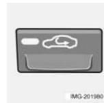
Рециркуляция используется для защиты салона от проникновения снаружи несвежего воздуха, выхлопных газов и т.п. Воздух циркулирует в салоне. Пока
