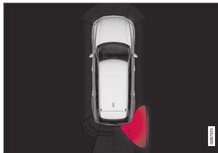
Rozsvícená ikona funkce CTA na grafice Systém parkovacího asistenta na obrazovce.
