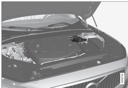
12 V atbalsta akumulators atrodas kastē blakus statnim.
