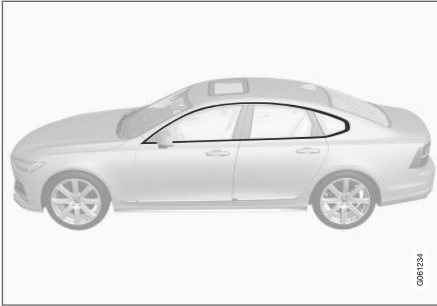
Alkatrészek, amelyek 3,5 és 11,5 pH-érték közötti tisztítószerezrel moshatók.
