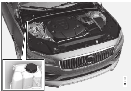
Hűtőfolyadék tágulási tartálya, balkormányos autó.
