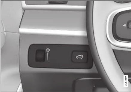
Forgókapcsoló (balra) a belső fényerő beállításához.
