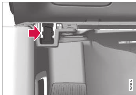
Az adatkapcsolati csatlakozó (On-board Diagnostic, OBDII) a vezető oldalon, a műszerfal alatt található.
