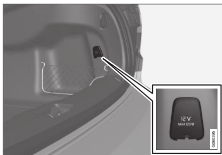
12 voltos elektromos aljzat a csomagtérben*.
