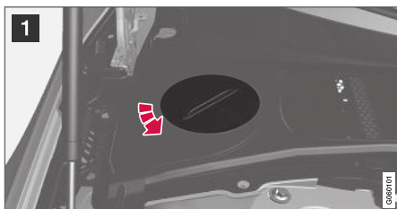
Hűtőfolyadék tágulási tartálya, balkormányos autó.
