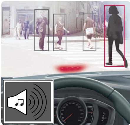
Automašīna ir aprīkota ar sadursmes brīdinājuma sistēmu ar automātisko bremzēšanu un velosipēdistu un gājēju aizsardzību, kas var brīdināt, bremzēt un/vai apturēt automašīnu, ja priekšā atrodas transportlīdzeklis, velosipēdis vai gājējs.
