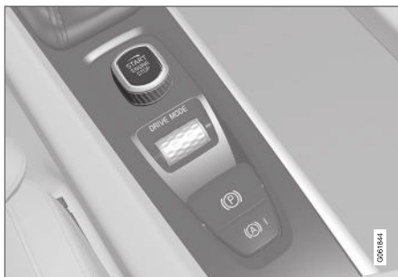
Pokrętło rozruchu na konsoli między fotelami.
