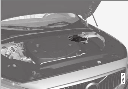
Akumulator pomocniczy jest umieszczony w skrzynce obok kolumny zawieszenia.
