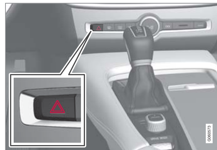
非常点滅灯ボタン
