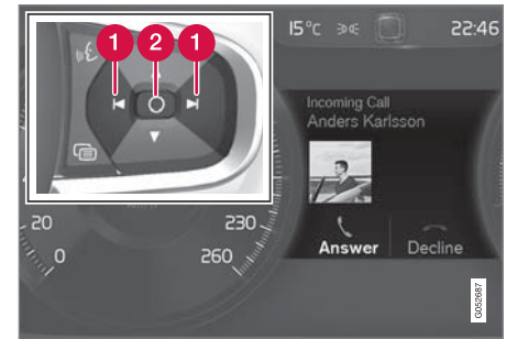
ドライバーディスプレイのメッセージとステアリングホイール右側のステアリングリモコン
