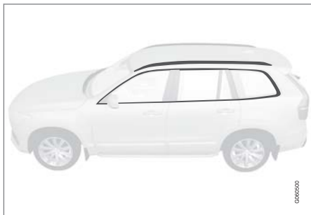
pH 値が 3.5～11.5 のクリーナーを使用して洗う必要のあるパーツ
