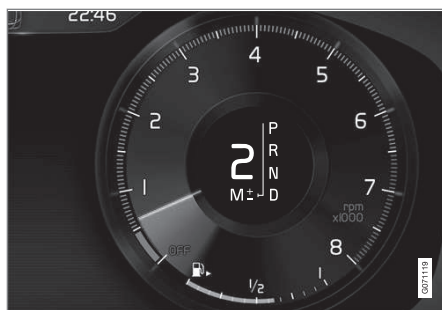
Écran conducteur lors du changement de rapport avec palettes au volant en mode manuel et grand levier de rapport.
