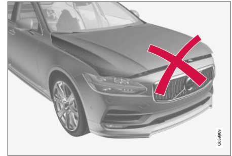
Niedomknięta pokrywa silnika.
