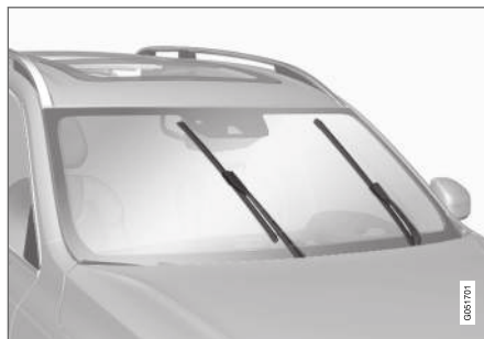
Pióra wycieraczek w pozycji serwisowej.
