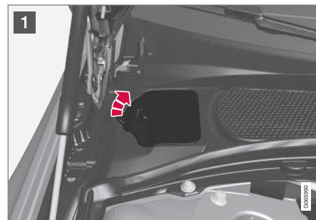
Ekspansjonsbeholder for kjølesystem.
