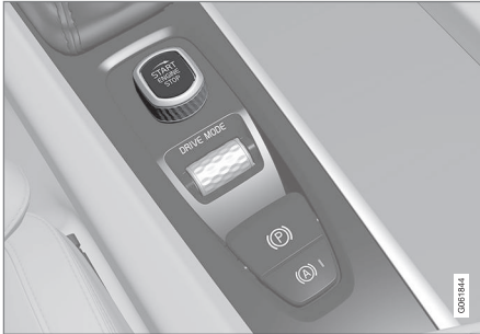
Startbryteren i tunnelkonsollen.
