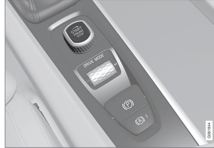
Tünel konsolundaki çalıştırma düğmesi.
