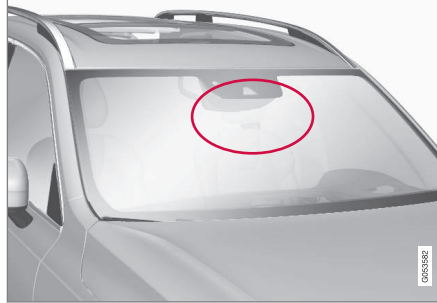
Radar ünitesi konumu
