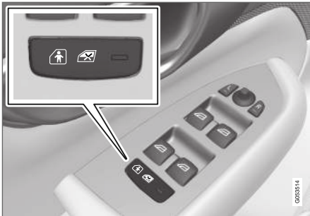
Pulsante di attivazione e disattivazione elettrica.
