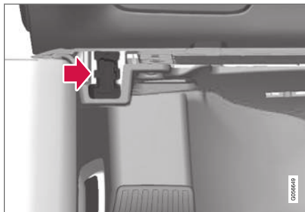
La presa diagnostica (presa On-board Diagnostic, OBDII) sotto il cruscotto sul lato conducente.
