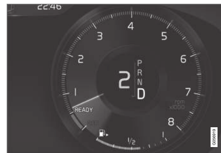
Display del conducente in caso di cambio marcia con le leve al volante.
