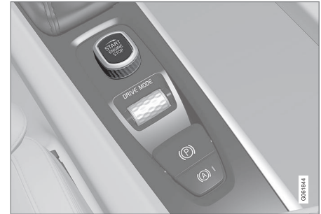
Pokrętko rozruchu na konsoli między fotelami.
