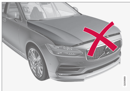
Niedomknięta pokrywa silnika.
