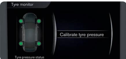
Il est toujours nécessaire d'effectuer un étalonnage après le remplacement d'un pneu ou un changement de la pression de gonflage. Lorsque le témoin (⚠) s'allume, il convient de contrôler la pression de gonflage et d'étalonner le système. Procédez comme suit :
