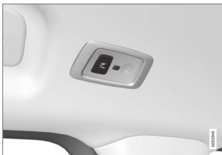
Les voitures équipées d'un toit panoramique* ont deux lampes, une de chaque côté du toit. 7
