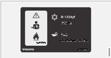
2 Autocollant du système de climatisation pour les voitures avec réfrigérant R1234yf.
