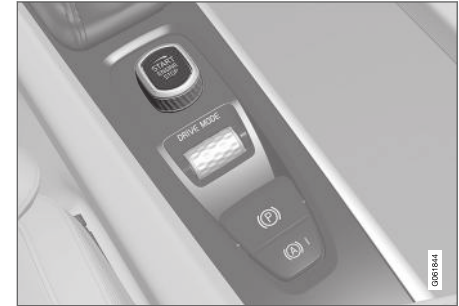
Tünel konsolundaki çalıştırma düğmesi.
