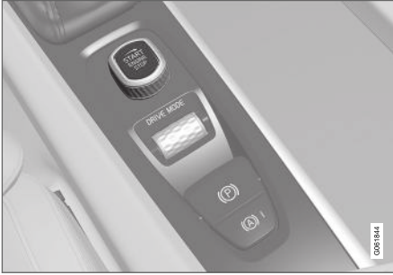
Tünel konsolundaki çalıştırma düğmesi.
