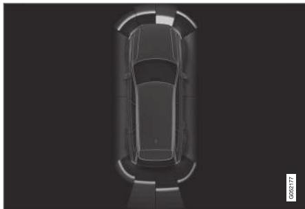
Bildeskjermvindu med hindringssoner og sensordetektorer.
