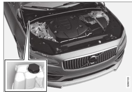
Ekspansjonsbeholder for kjølesystemet, bil med venstrestyrt.
